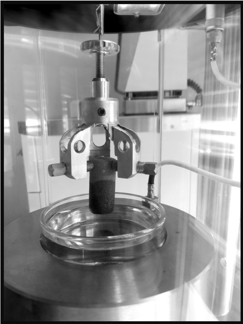
15 Abb. 2: Messung der Flüssigkeitsaufnahme, um die Kapillarkonstante und die Kontaktwinkel von PER und Wasser bestimmen zu können
